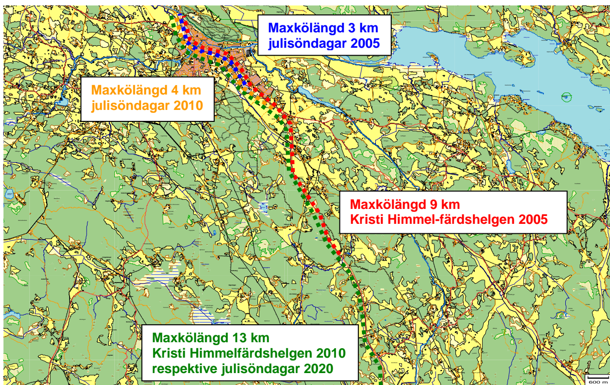
Figur 5 Troliga maxkölängder i norrgående riktning i Söderköping under åren 2005 och 2020.
